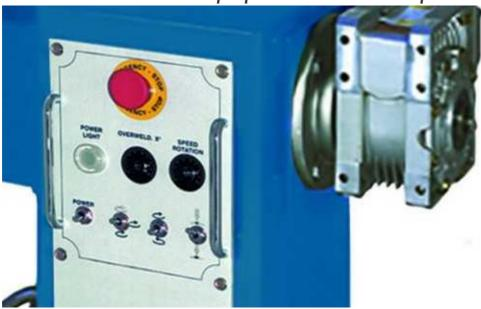
Panneau de commande intuitif avec réglage de la vitesse de rotation, inversion de la rotation et réglage du recouvrement
