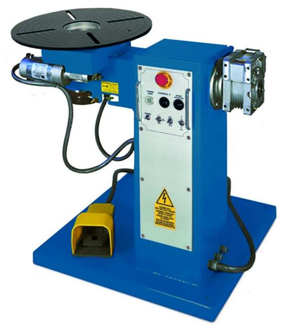
Positionneur de soudage inclinable à vitesse réglable pour le soudage mig mag de pièces en rotation
