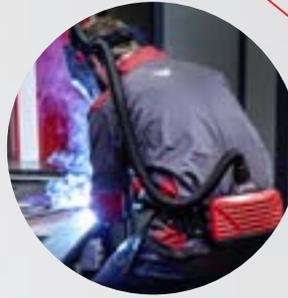
Le système de protection respiratoire à ventilation fiable, filtre jusqu'à 99,8 % des particules nocives de l'air ambiant du soudeur.
